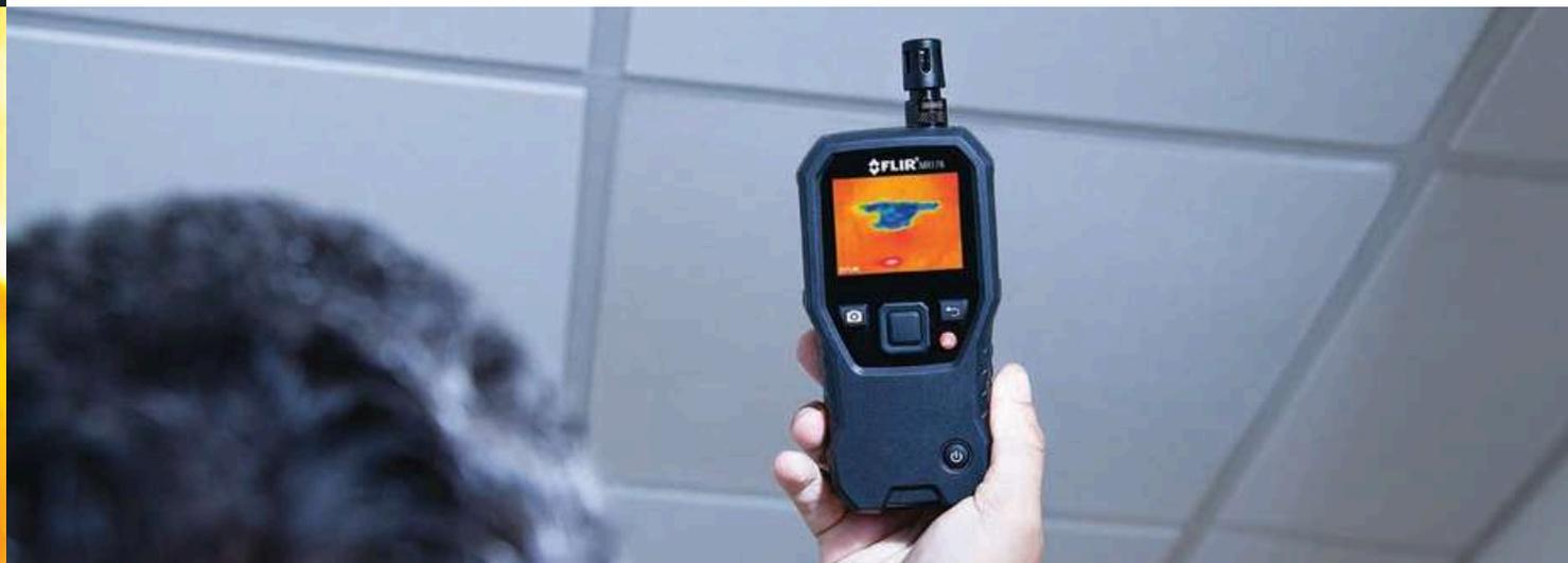
Con la tecnología IGM del sensor termográfico incorporado, el MR176 y el MR160 le orientan visualmente hacia el lugar exacto en el que puede ocultarse la humedad.
