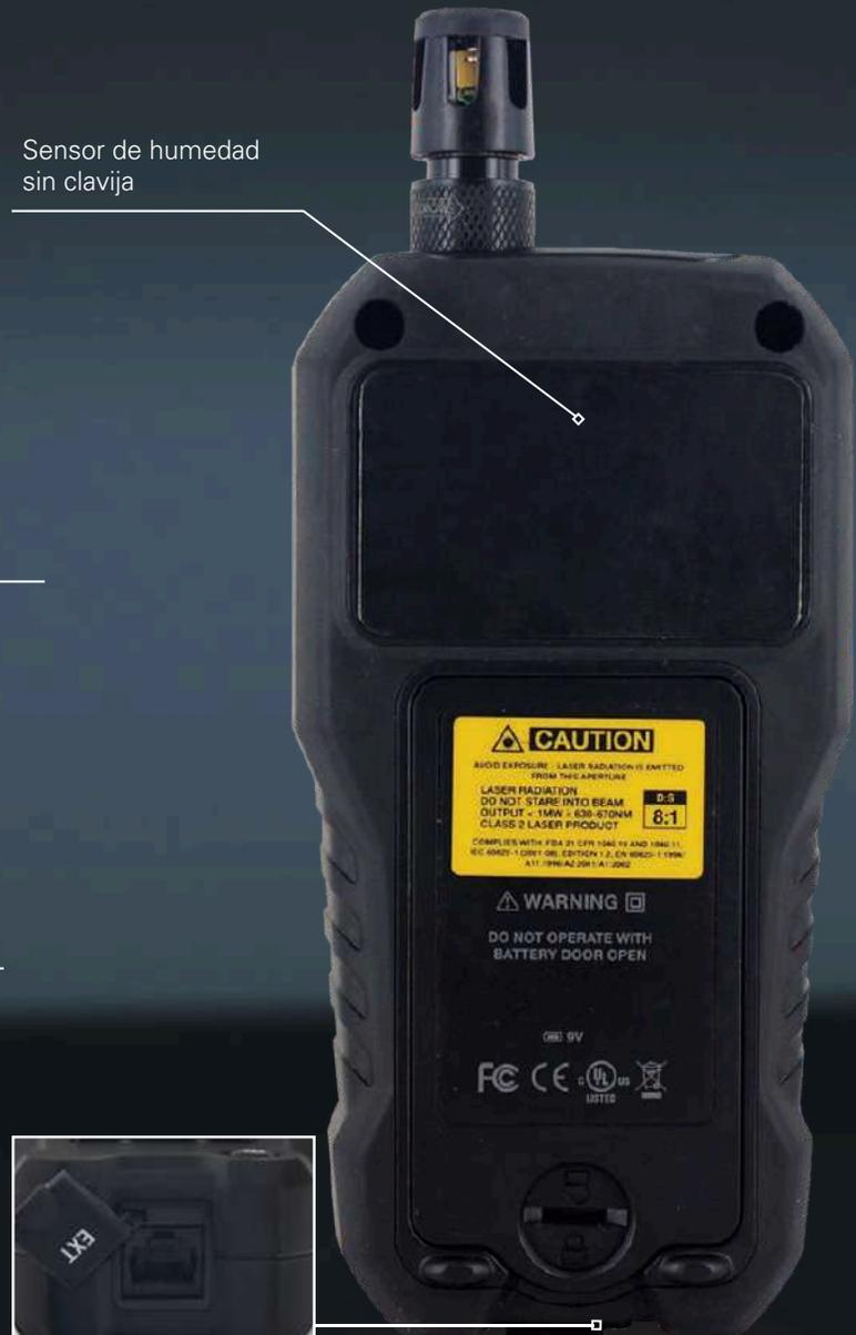
Sensor de humedad sin clavija
