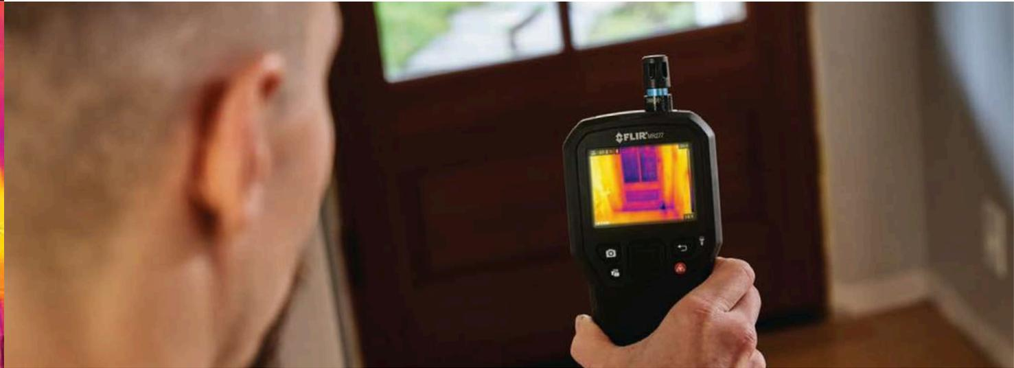
Combinando las ventajas de un sensor generador de imágenes de infrarrojos, la tecnología de imagen FLIR MSX® y un puntero láser, el sistema todo en uno de inspección de edificios MR277 le ayuda a localizar rápidamente, identificar claramente y documentar con facilidad problemas críticos de humedad y de la envolvente del edificio.
